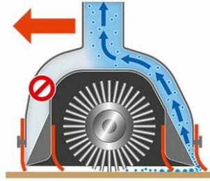
**Zwei-Wege-System für schnelle Trocknung:** Zwei Gumilippen im Saugfuß wechseln bei der Reinigungsfahrt zwischen Vorwärts- und Rückwärtsbewegung ab –
