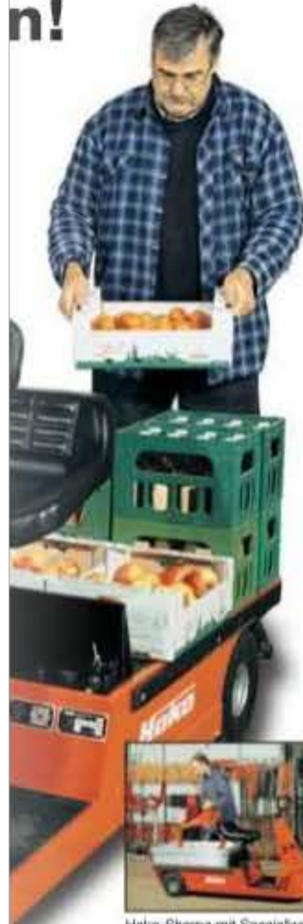
Hako-Sherpa mit Speziallade- fläche für lackierte Teile
