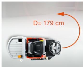
**Utilisation possible dans les couloirs étroits** grâce à un design compact. Angle de braquage de 90°, diamètre de braquage de 179 cm seulement.
