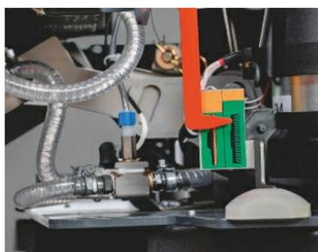
**Indicateur d'usure pour les brosses** et les disques et système d'accrochage et décrochage des brosses automatique.
