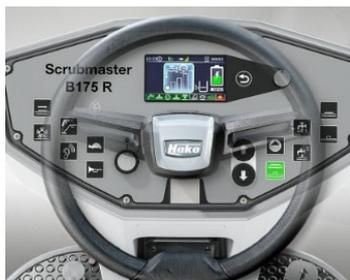
**Maîtrise totale** : commande à un seul bouton très pratique. En mode Slow (vitesse ralentie), la vitesse est abaissée à 3,5 km/h par simple pression sur un bouton, pour un nettoyage encore plus minutieux. La touche Boost active la pression d'eau et de brossage maximale.
