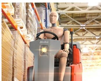
**Visibilité optimale** : le siège conducteur est positionné afin que l'opérateur bénéficie d'une visibilité parfaite sur son périmètre de travail.
