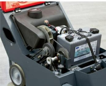
**Propulsion électrique par batterie sans entretien :** le chargeur embarqué peut être branché sur n'importe quelle prise.
