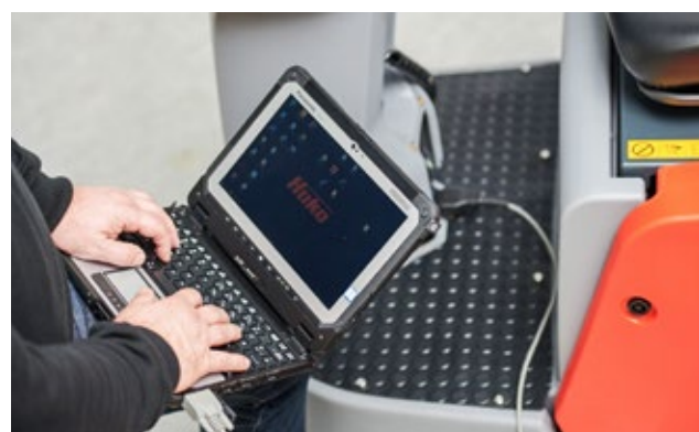
Einfacher Zugang zur Diagnose-Schnittstelle für Wartung und Modifikation von Fahreinstellungen.
