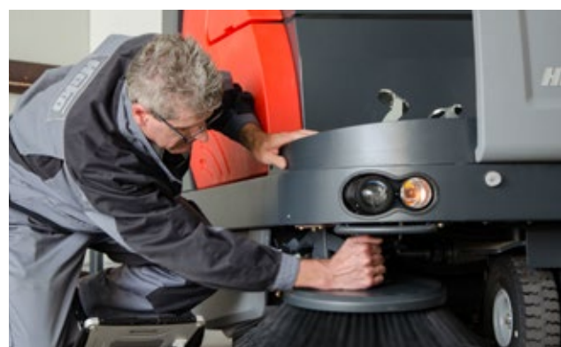
Vereinfachte Wartung und Servicearbeiten durch gute Zugänglichkeit zu allen relevanten Komponenten
