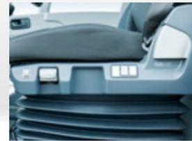
**Luftgefederter Sitz** mit Sitzheizung und Lendenwirbelstütze
