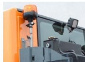
**Rundumkennleuchte (LED)** und Arbeitsscheinwerfer hinten (LED)
