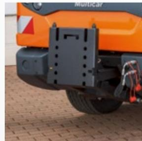
Frontlift mit Geräteplatte als Vorbau-Schnellwechselsystem mit Hub-, Senk- oder Schwenkfunktion zur einfachen Aufnahme verschiedenster Vorbaugeräte
