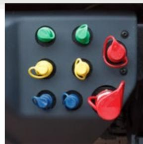
Variable Hydraulik: von einfacher Kipphydraulik über Stationärhydraulik bis LS-Mobilhydraulik mit Komfortbedienung und Hochdruckumschaltung
