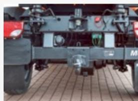
**Kugelkopf-/Bolzenkupplung** mit einer Stützlast von 150 bzw. 250 kg
