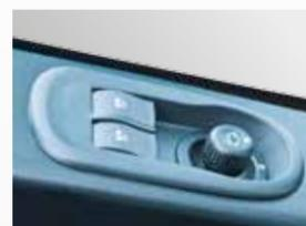
**Lève-vitres et réglage électrique des rétroviseurs** gauche et droite
