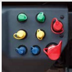
Système hydraulique variable : simple dispositif hydraulique de bascule, système stationnaire ou même système hydraulique mobile LS avec commande grand confort et commutation haute pression
