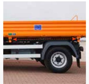
Poids de l'ensemble jusqu'à 7,5 t, charge utile jusqu'à 3,1 t et charge remorquée freinée jusqu'à 3,5 t
