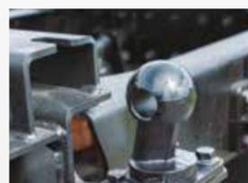
**Système de changement à rotules** pour le montage et le démontage facile d'outils
