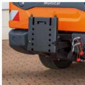
Relevage avant avec plaque pour le changement rapide d'outils à l'avant et fonctions de levage, d'abaissement et de pivotement pour l'installation facile des outils les plus divers à l'avant
