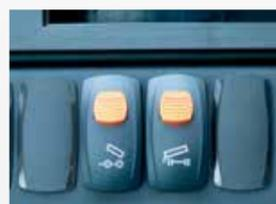
**Dispositif hydraulique de bascule de remorque** Commutateurs facilement accessibles
