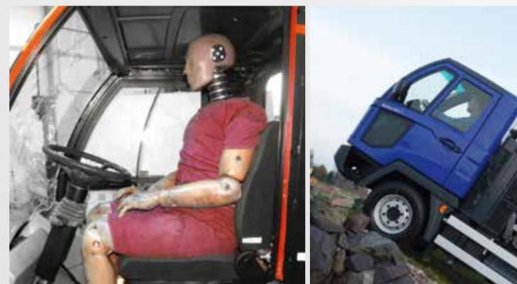
La sécurité des conducteurs nous tient à cœur. Pour cela, nous effectuons des tests de sécurité conformément aux règles CEE-ONU 29 et 13. Ils nous permettent de garantir que nos véhicules offrent le plus grand degré de sécurité possible..
