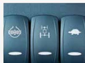
**Verrouillage du différentiel, transmission intégrale et vitesse rampante** activation en appuyant sur un bouton
