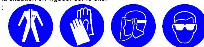
Protection individuelle : Portez des vêtements de protection appropriés, de combinaison ou de costume, et des bottines de sécurité identiques conforme à la norme NE 365/367 respectivement NE 345 en cas d'utilisation fréquente ou prolongée et en cas d'exposition excessive. Matériau approprié: néoprène. Indication du temps de perméabilité: 6 heures.
